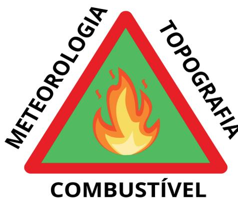
Figura 3: Triângulo do Comportamento do Fogo.
